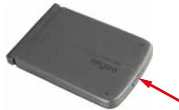
2.電池ボックスの蓋を矢印方向へスライドさせて開きます。
