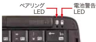
「Fn」と「半角/全角」キーを同時に長押しするとペアリングLEDが青色に点滅し、キーボードがペアリングモード(他のBluetooth機器から検索可能な状態)になります。ペアリングに成功、もしくは失敗(タイムアウト)しますとLEDは消灯します。タイムアウト時間は10分ですので、時間内にペアリングに成功しませんがスリープモードに入りLEDが消灯します。
