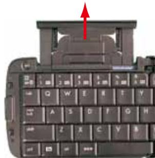
2.丸印部分を持ち、上方向に持ち上げながら引き抜きます。
