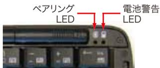
**Fnキーを押したままBluetoothマークを押し、そのまま10秒ほど長押し**しますと「ペアリングLED」が青色に点滅し、キーボードがペアリングモード(他のBluetooth機器から検索可能な状態)になります。ペアリングに成功または失敗(タイムアウト)するとLEDは消灯します。ペアリングのタイムアウト時間は10分間ですので、時間内に成功しないとスリープモードに入りLEDが消灯します。「電池警告LED」はキーボードの電池残量が少なくなると赤く点滅します。点滅を始めたからお早めに新しい電池
