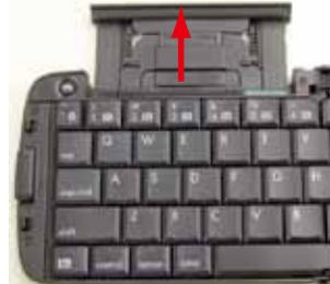
2. 丸印部分を持ち、上方向に持ち上げながら引き抜きます。
